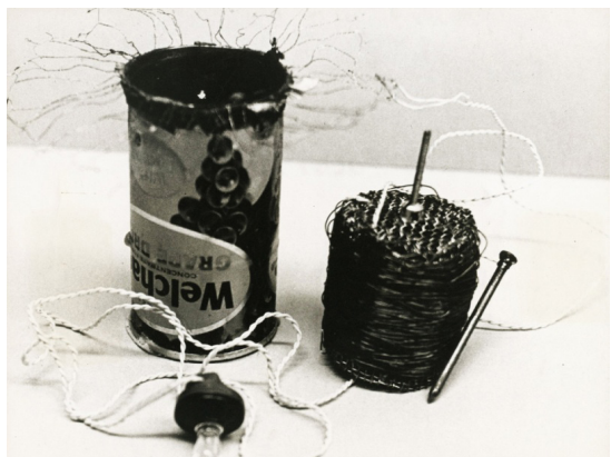
تصویر: رادیو ترانزیستوری معروف پاپانک، طراحی شده برای جنگل نشینان جزایر دوقانده بریتوی اندونزی، حدود ۱۹۴۲، منبع انرژی: کد گوی، قیمت تمام‌شده: ۹ سنت! اسمیل «طراحی پایدار»
